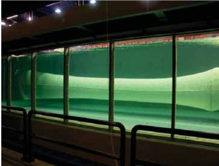
Figur 3. Seksjon testet i prøvetanken i Hirtshals; lengde 12 m, diameter 2 m, maskestørrelse 24 mm, trådtykkelse 1.16 mm, 40 % maskeåpning (alle tall i ustrukket tilstand).
