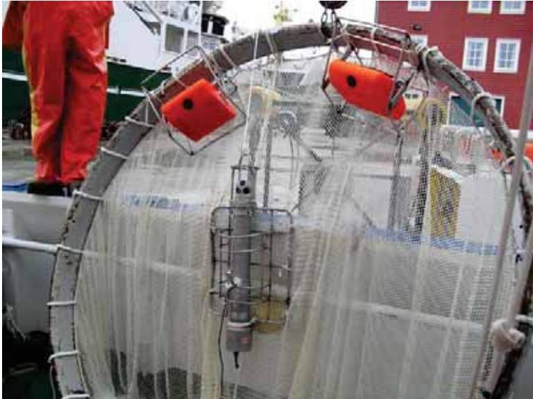
Figur 2. Scanmar trålfartsmålere og Nortek ADCP måler plassert i åpningen på MIK ringen for kalibrering.
