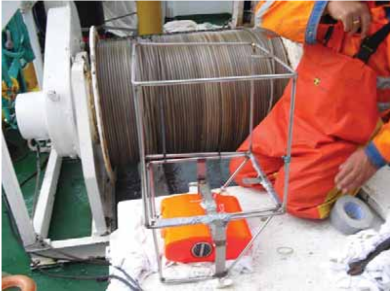
Figur 5. Scanmar fartsmåler plassert i stativ som ble festet til taket i nettsylindere
