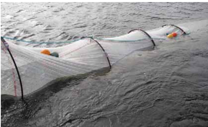
Figur 2. En 15 m lang nettsylinder holdt utspent med 1,5 m dia. PVC ringer testet for "bøtteeffekt" om bord i M/S "Fangst".
