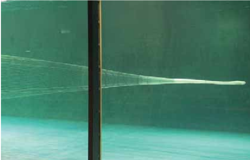
Figur 3. Måling av geometri i en flytetral i 1:20 skala når denne ble utsatt for en simulert fangstbelastning.
